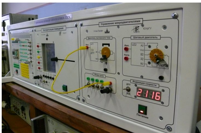
Рис. 2. Стенд для исследования систем управления электроприводов и логических устройств автоматики
