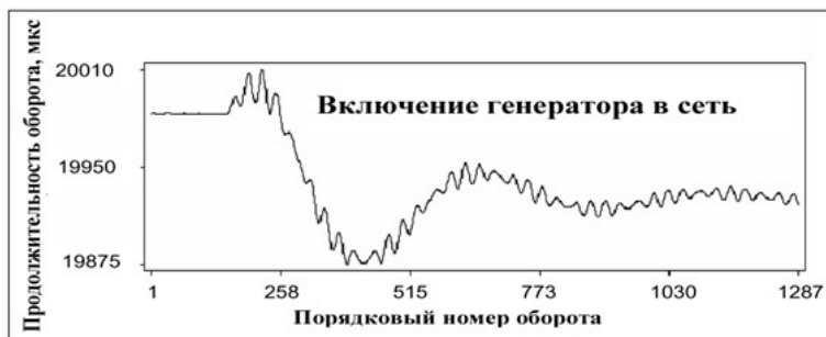
Рис. 6. Включение генератора в сеть
