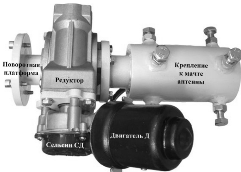
Рис. 3. Электропривод поворотной узконаправленной антенны
