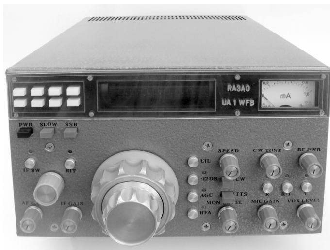
Рис. 7. Коротковолновый вседиапазонный трансивер. Внешний вид аппарата
