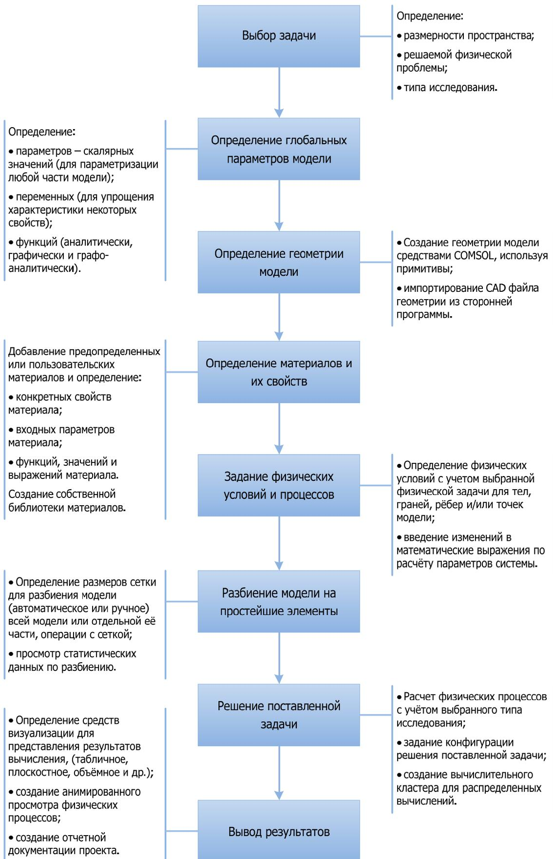
Рис. 1. Алгоритм моделирования в среде COMSOL Multiphysics
