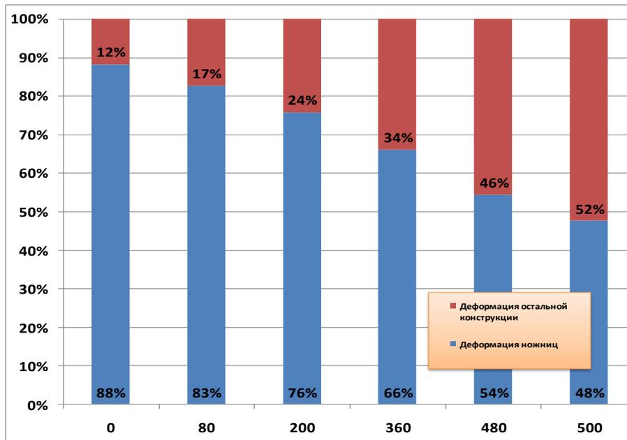
Рис. 7. Распределения деформаций между тягами ножиц и остальной конструкцией
