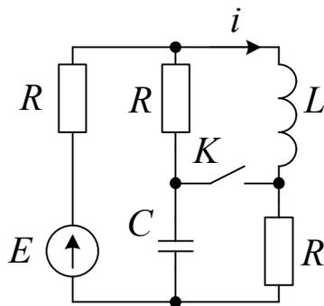
В качестве примера рассмотрим мостовую схему цепи, в которой необходимо найти преходящий ток индуктивности после замыкания ключа  $K$ .
