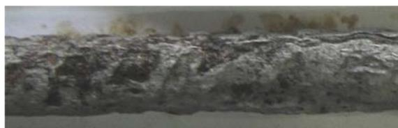
**Рис. 4в.** То же очищено в 10% HCl
