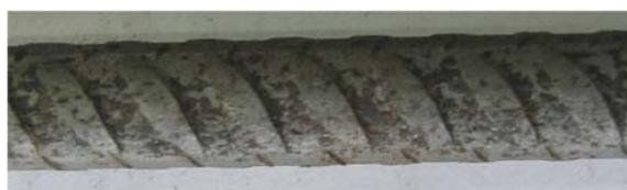
**Рис. 4а.** Арматура  $\varnothing$ 6A400 до коррозии
