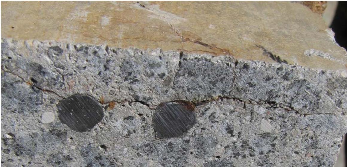
**Рис. 5.** Продольная трещина, характерная для элементов с двумя стержнями арматуры в растянутой зоне
