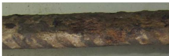
**Рис. 4б.** То же после коррозии
