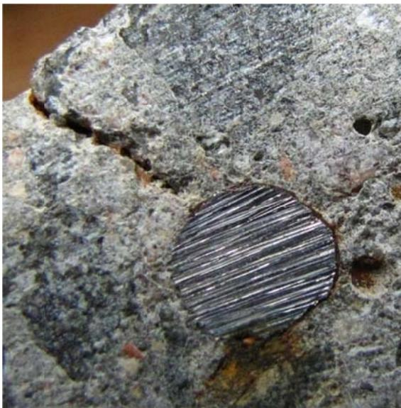
**Рис. 3.** Сечение с продуктами коррозии
