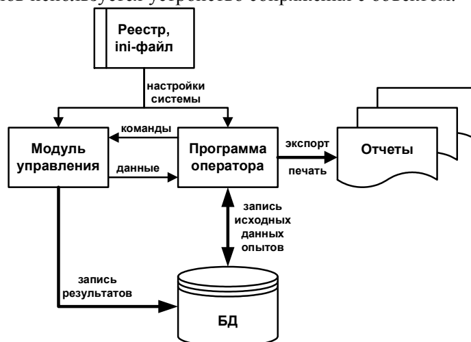
Рис. 4. Структурная схема и потоки данных программного обеспечения.
