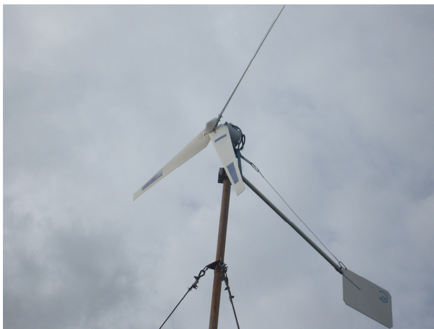
Рис. 2 Установка ветроэлектрическая УВЭ 500
