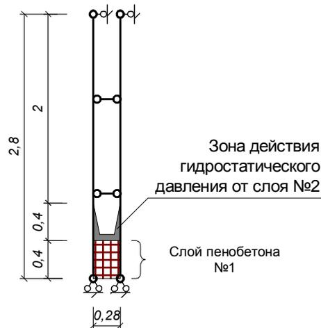
Рис.5. Расчетная схема кирпичной стены, обшивки из ГКЛ по металлическому каркасу и промежуточных слоев пенобетона.
