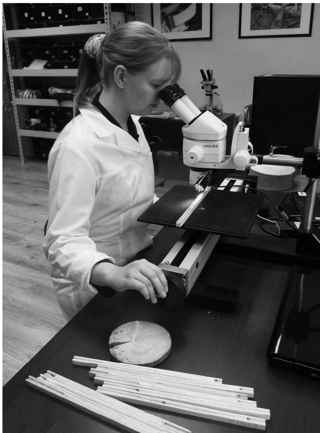
Рис. 3. Измерения годовых колец по кернам модельных деревьев на приборе LINTAB выполняет С. В. Лежнева
